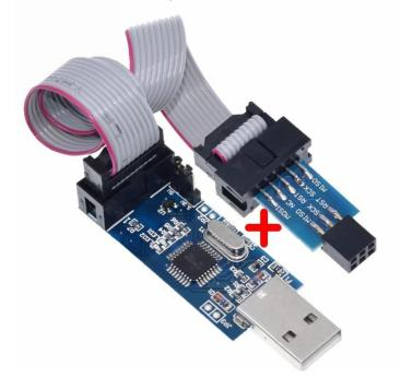
Подключаем программатор к компьютеру. Устанавливаем к нему драйверы из папки **«usbasp-windriver»**. После успешной установки переходим в **«свойства:Мой компьютер -> Диспетчер устройств»**. Должно появиться новое устройство:
