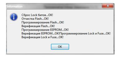
Это означает, что микроконтроллер на плате Arduino Nano успешно прошит!
