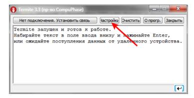
В поле «Параметры порта» выбираем СОМ-порт, к которому подключена плата, и так же выбираем скорость 57600 бит/с, и нажимаем «ОК»
