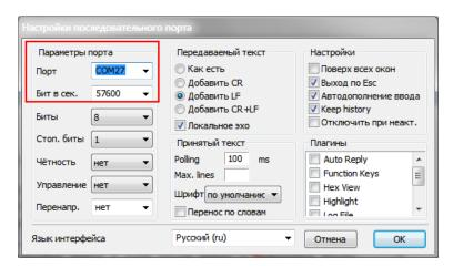
Если информация не появилась, то следует в окне терминала нажать кнопку «Очистить» и нажать кнопку RESET на плате Arduino Nano, после чего должна появиться информация:
