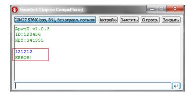
Чтобы повторить попытку нужно нажать кнопку RESET на плате Arduino Nano и заново ввести КОД.
